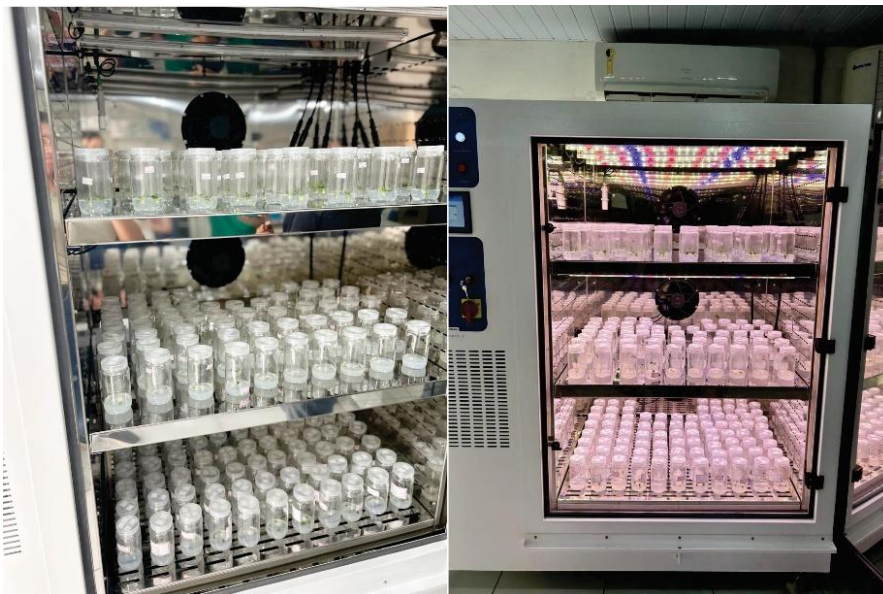
Figura 1. Experimento de germinação de sementes de Cedrela fissilis conduzido em câmara climática (TE-4002/3) com duas concentrações de CO 2 (420 e 800 ± 30 ppm) e vedação (2 e 4 membranas porosas).
