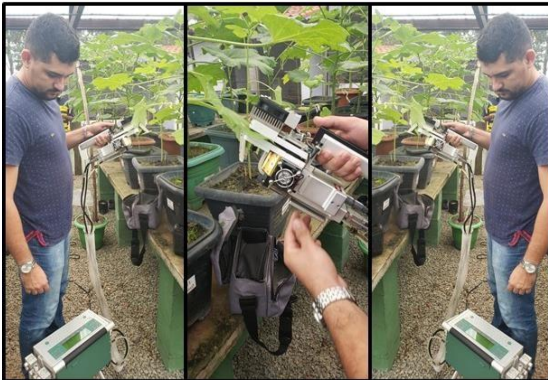
FIGURA 3. Determinação das trocas gasosas por meio do equipamento IRGA.
