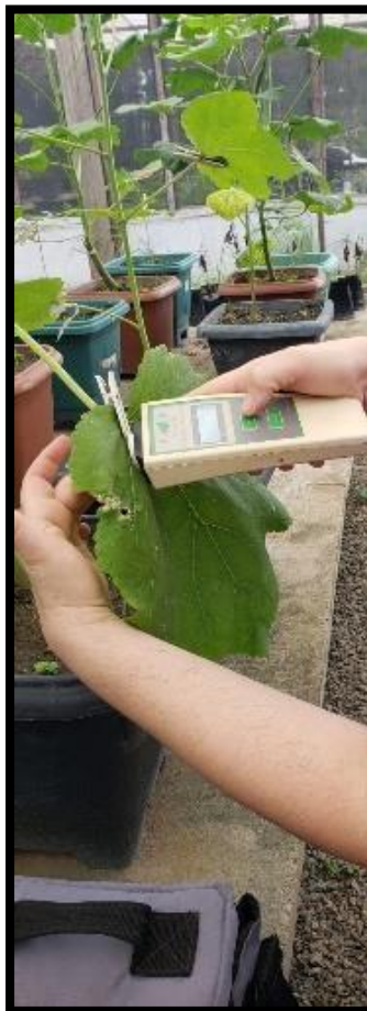
FIGURA 4. Determinação da Eficiência Fotoquímica máxima do PSII por meio do equipamento Pocket-PEA.
